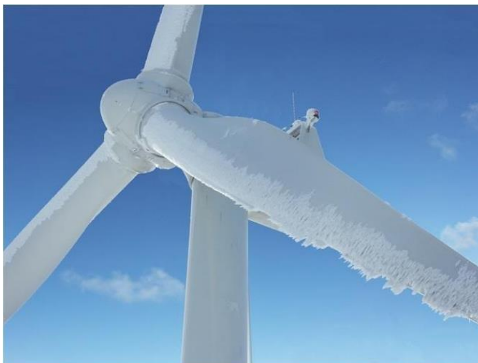
Рис. 7.2. Приклад обледеніння лопатей
