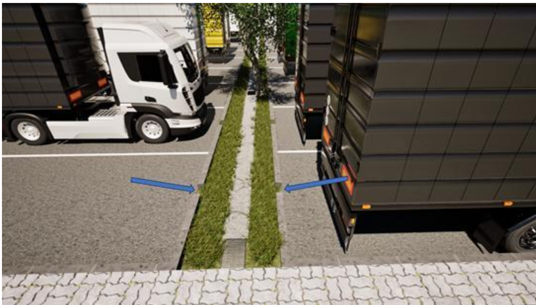
Рис. 11. 3. Візуалізація відкритої водовідвідної системи
