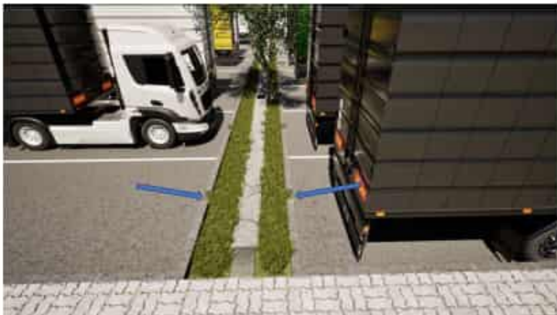
Рис. 11. 4. Візуалізація відкритої водовідвідної системи
